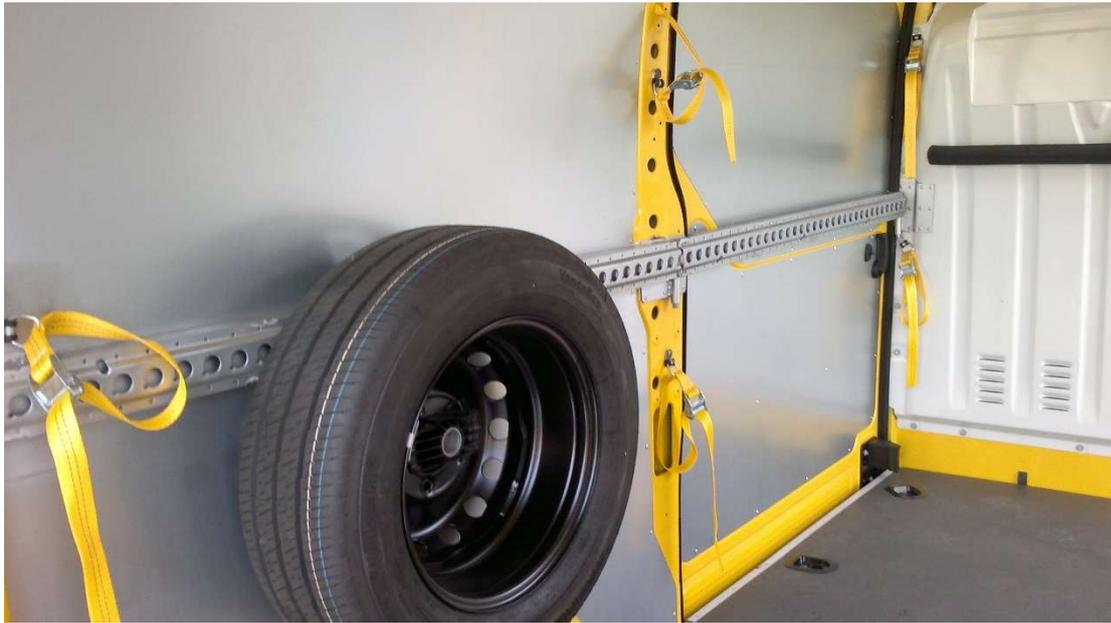
Las 2 bandas de amarre de eslingas (2 metros de longitud) en la mampara de separación, cuya función es la sujeción del segundo carro contra la mampara de separación.
